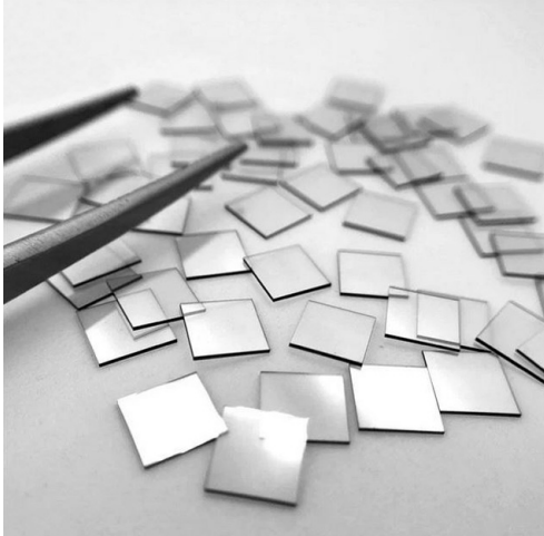
Im Labor hergestellte weiße CVD-Diamantsamen für die Züchtung von CVD-Diamantkristallplatten
